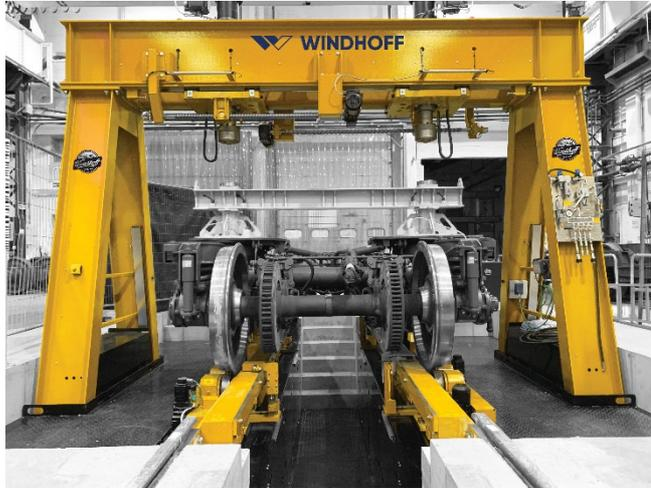
Der Drehstellmessstand dient zur Bestimmung von Radaufstandskräften und zur geometrischen Vermessung von Drehstellen. Die beweglichen Prüfzylinder sind mit Kraft-/Weg-Messeinrichtungen ausgerüstet. Dadurch kann bei verschiedensten Drehstellen und Belastungen die Radlastverteilung geprüft werden. Weitere Messaufgaben können aus Kontrolle der Achsabstände, der Randrücken-Abstände und verschiedenster Drehstell-Einbaumasse bestehen.
