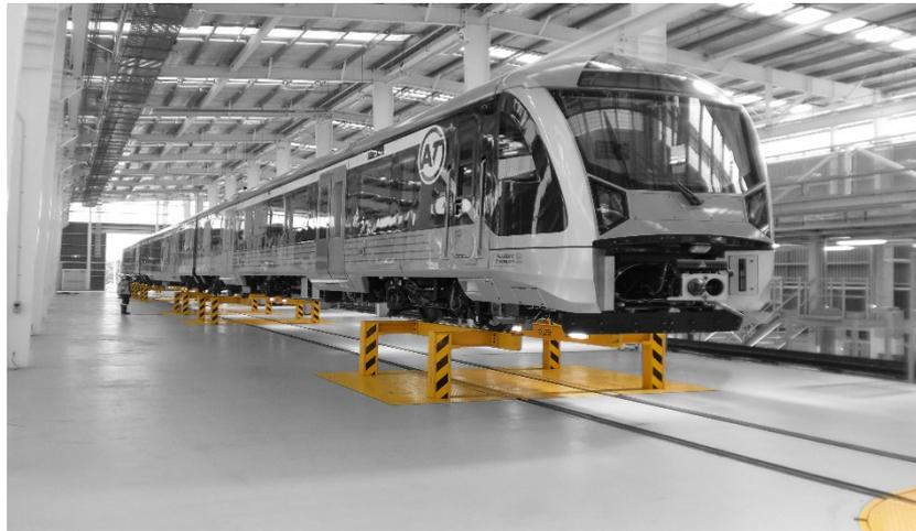
Die Anforderungen an Maschinen für Wartungs- und Instandhaltungsaufgaben in Bezug auf die Sicherheit werden immer höher. Hebebockanlagen dienen zum Heben und Senken von Schienenfahrzeugen und unterliegen hohen Sicherheitsstandards. Sie werden in Bahn-Betriebswerken eingebaut, um Wartungen und Reparaturen von Schienenfahrzeugen effizient durchführen zu können. Unsere Produktpalette soll um eine neue Lastklasse erweitert werden.
