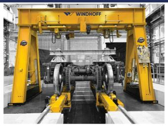
Der Drehgestellmessstand dient zur Bestimmung von Radaufstandskräften und zur geometirischen Vermessung von Drehgestellen. Die beweglichen Prüfzylinder sind mit Kraft-/Weg-Messeinrichtungen ausgerüstet. Dadurch kann bei verschiedensten Drehgestellen und Belastungen die Radlastverteilung geprüft werden. Weitere Messaufgaben können aus Kontrolle der Achsabstände, der Radrücken-Abstände und verschiedenster Drehgestell-Einbaumasse bestehen.
