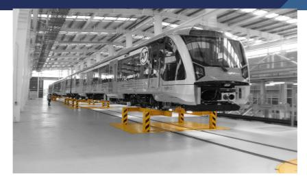
Die Anforderungen an Maschinen für Wartungs- und Instandhaltungsaufgaben in Bezug auf die Sicherheit werden immer höher. Hebebockanlagen dienen zum Heben und Senken von Schienenfahrzeugen und unterliegen hohen Sicherheitsstandards. Sie werden in Bahn-Betriebswerken eingebaut, um Wartungen und Reparaturen von Schienenfahrzeugen effizient durchführen zu können.
